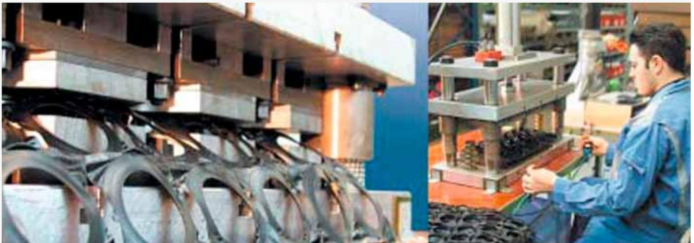
Der Wechsel von Eilhub auf Krafthub ist unmerklich. Die Kraft wird sanft aufgebaut und gesteigert. Dadurch wird das Material sauber bearbeitet und das Werkzeug wird geschont.
