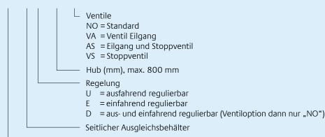
Ölbremszylinder P40 mit seitlichem Ausgleichsbehälter (RP), ausfahrend regulierbar (U), der Hub beträgt 100 mm (100) und das Ventil (NO) ist Standard.
