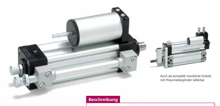
Ölbremszylinder übernehmen in Zusammenarbeit mit Pneumatikzylindern die Aufgabe, einen gleichmäßigen Vorschub zu gewährleisten, sowie die Geschwindigkeit zu regeln. Es wird eine axiale äußere Kraft auf die Kolbenstange eingeleitet, dadurch strömt Öl über ein Drosselventil, um von einer Kammer in die andere zu gelangen. Durch den nahezu konstanten Volumenstrom des Öles werden die Geschwindigkeitsschwankungen des Pneumatikzylinders bei wechselnden Lastverhältnissen abgefangen und neutralisiert.
