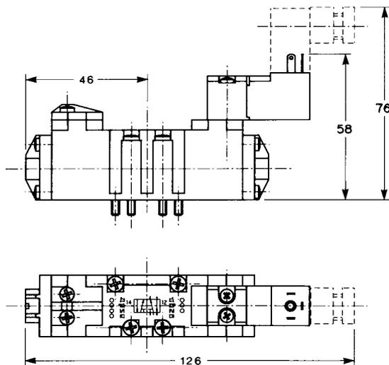
Ventil 5/2 - 5/3 für Grundplattenmontage - Beidseitiger elektrischer Impuls
