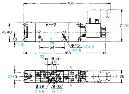
Doppelter elektrischer/pneumatischer Impuls mit Pilotventil 15 mm um 90° gedreht und pneumatischem Impuls am Ventilgehäuse - Spule U05
