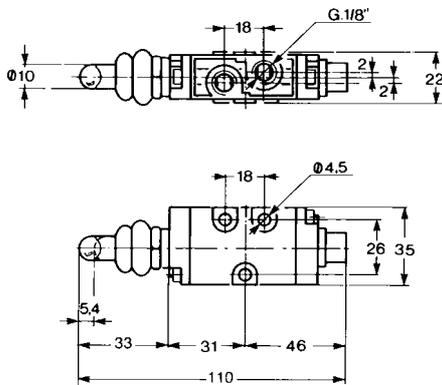
Ventil mit Kugelstößel mit Staubschutz 5/2 - G 1/8
