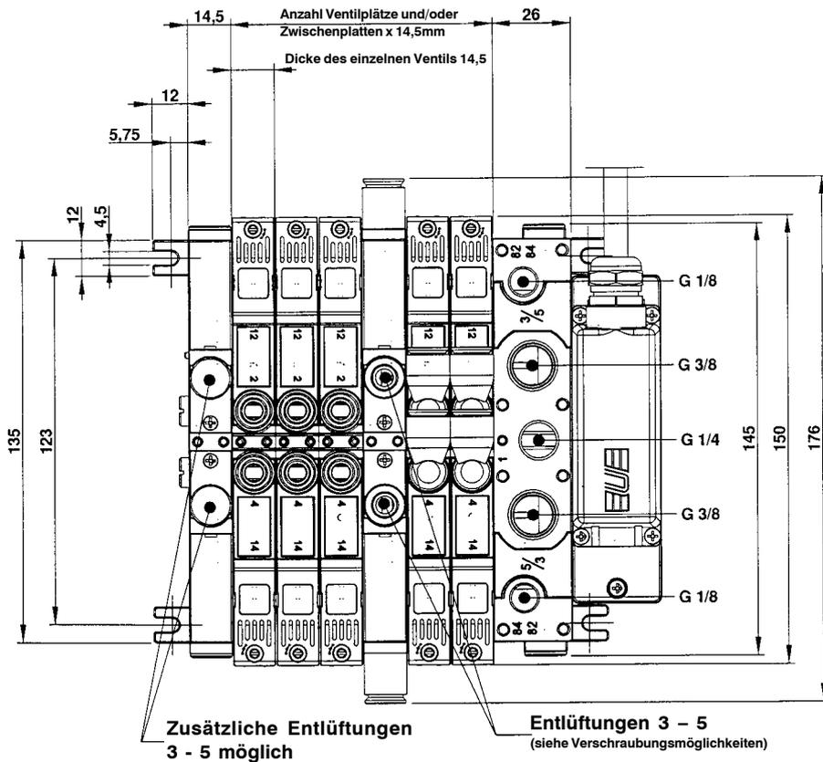
Serie PSC mit Eintrittsplatte 26 mm und Endplatte 14,5 mm mit DIN-Führung
