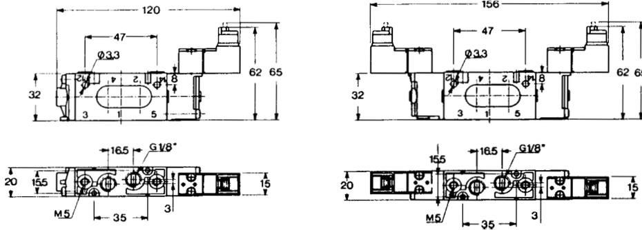
Elektrischer Einzel-Doppel - Impuls mit Pilotventil 15 mm um 90° gedreht und Miniatur - Stecker - Spule U05
