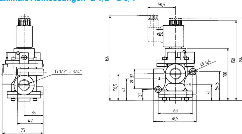
Maximale Abmessungen G 1
