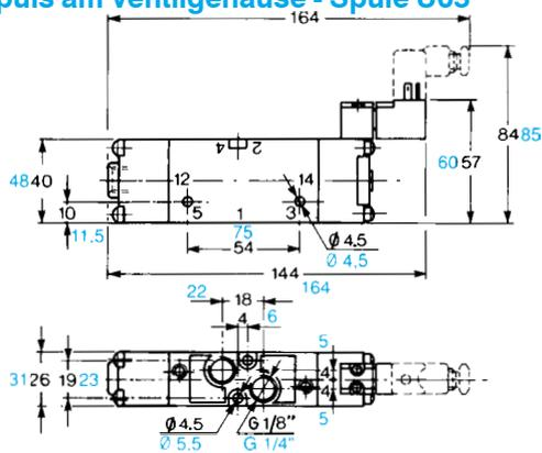
Doppelter elektrischer/pneumatischer Impuls mit Pilotventil U1 um 90° gedreht/H und pneumatischem Impuls am Ventilgehäuse
