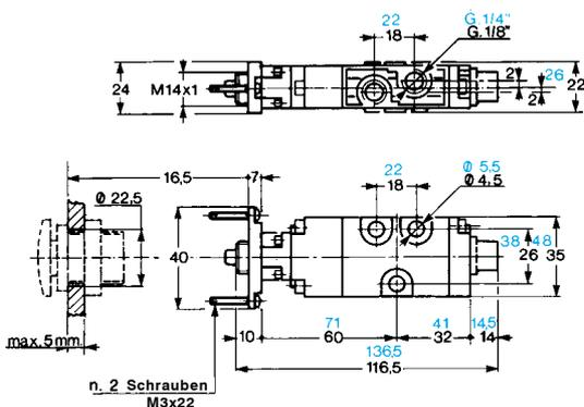
Grundventil 5/2 mit indirekter Steuerung von Schalttafel aus G 1/8 - G 1/4
