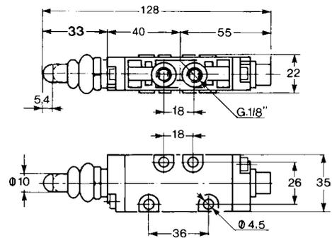
Ventil mit Rollenstößel mit Staubschutz 3/2 - G 1/8
