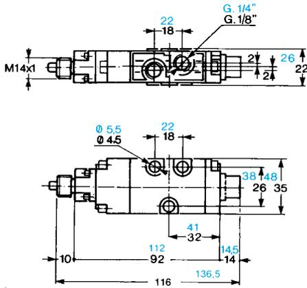
Grundventil 5/2 mit indirekter Steuerung durch Kugelstößel und sensiblen Kugelstößel G 1/8 - G 1/4
