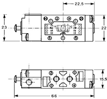
Ventil 5/2 - 5/3 - Beidseitiger pneumatischer Impuls (Ventilgehäuse mit Gewinde)
