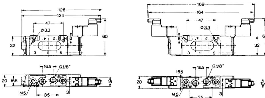
Doppelter elektrischer/pneumatischer Impuls mit Pilotventil 15 mm um 90° gedreht; Miniatur -Stecker in Linie/um 90° gedreht und pneumatischem Impuls am Ventilgehäuse/am Kopf
