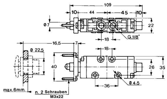
Grundventil 3/2 mit indirekter Steuerung von Schalttafel aus G 1/8 G 1/8 - G 1/4
