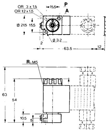
**PILOTVENTIL U1, Gewindeanschlüsse G 1/8**
