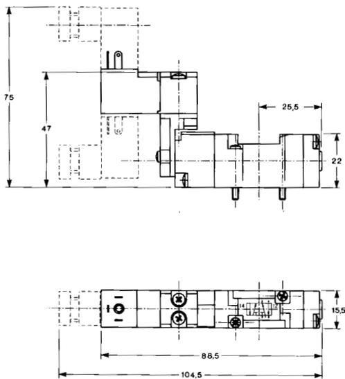
Ventil 5/2 - 5/3 - Beidseitiger elektrischer Impuls mit Halterung
