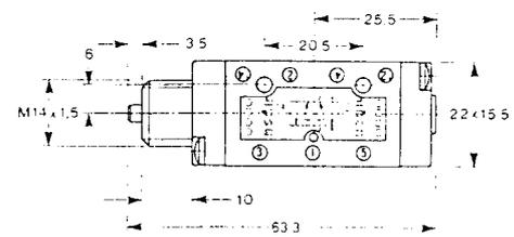
Ventil 5/2 - mechanische Schalttafelbetätigung (Gewinde am Körper)
