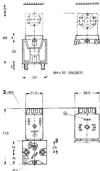
**PILOTVENTIL U1, Batteriemontage mit Zugstangen**
