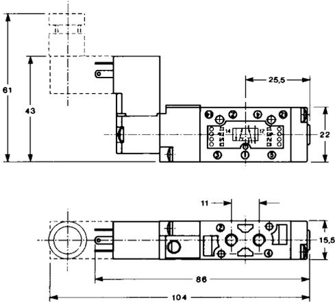
Ventil 5/2 - 5/3 - Beidseitiger elektrischer Impuls (Ventilgehäuse mit Gewinde)
