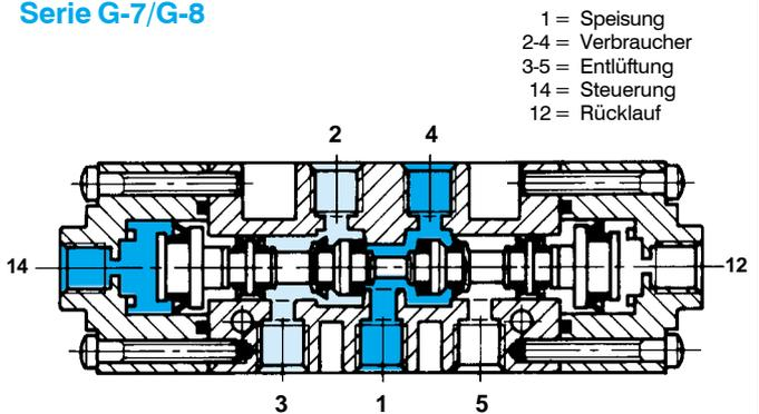
Dieses System, seit Jahren in Produktion und daher bestens erprobt, empfiehlt sich für alle jene pneumatischen Anwendungsgebiete, in denen keine speziellen Kreisläufe notwendig sind. Das günstige Preis/Leistungs-Verhältnis (hohe Umschaltgeschwindigkeit, hohe Anzahl an Schaltungen, hoher Durchfluß) macht dieses im Mischsystem produzierte Ventil finanziell besonders günstig und passend für viele Anwendungsarten
