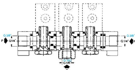
Wenn die Entlüftung nicht geregelt werden soll, den Plastikeinsatz entfernen und die Regelschraube eingeschraubt lassen
