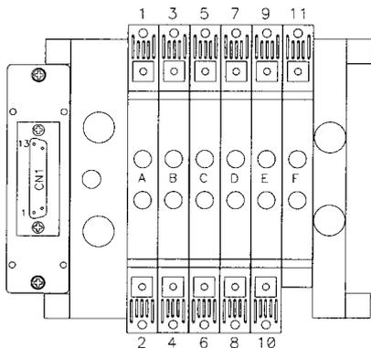
Beispiel zur Positionsidentifizierung in einer Batterie Typ D, gemischt, bistabil und monostabil, max. 20 out, Modul TIM20M verwenden, die Verbindung der zwei bistabilen Spulen erfolgt nach der letzten monostabilen Spule.
