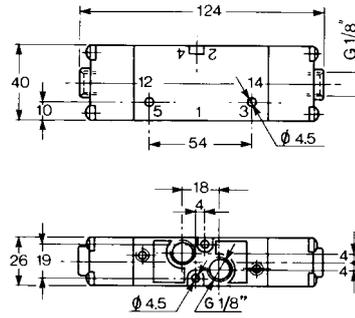
Pneumatischer Einzel-Doppel - Impuls am Gehäuse
