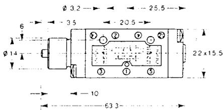
Ventil 5/2 - mechanische Schraubenbetätigung (Gewinde am Körper)
