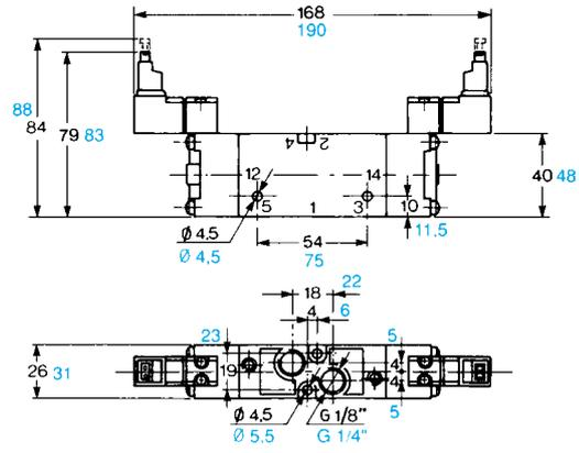
**Elektrischer Einzel-Doppel - Impuls mit Pilotventil 15 mm um 90° gedreht und Miniatur-Stecker um 90° gedreht - Spule U05**
