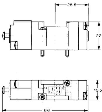
Ventil 5/2 - 5/3 - Beidseitiger pneumatischer Impuls (Grundplattenmontage)
