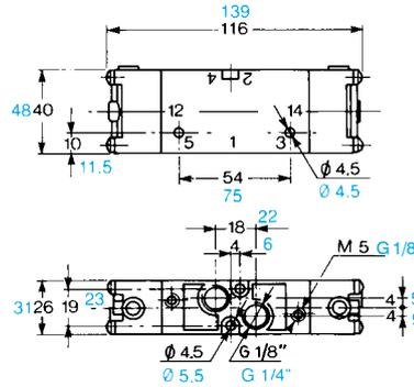
Elektrischer Einzel-Doppel - Impuls mit Pilotventil 15 mm um 90° gedreht und Stecker - Spule U05
