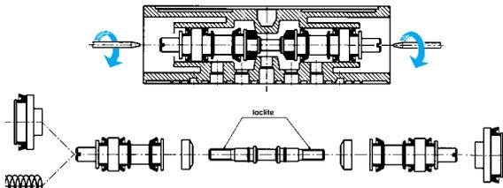
Montage und Demontage siehe Abbildung. Die Halbschieber unter Verwendung von Sicherheitsflüssigkeit wieder zusammenmontieren. Die Ersatzteilsätze beinhalten alle Innenteile für den einseitigen und beidseitigen Impuls. Für den Austausch des Pilotventils Artikel AA-0400 bestellen.
