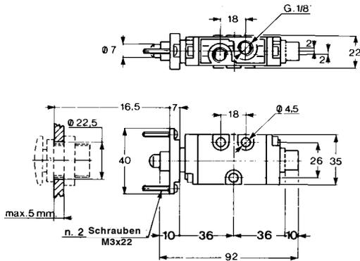
Grundventil 5/2 mit direkter Steuerung von Schalttafel aus G 1/8
