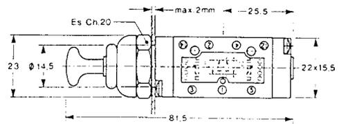
Ventil 5/2 - mechanische Betätigung (Gewinde am Körper)
