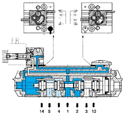
Aus der Zeichnung links geht hervor, daß es aufgrund der Konstruktionstechnik des inneren Systems der UNIVER Ventile nötig ist, - wenn der Luftstrom von der Speisung (1) zum Verbraucher (4) fließen soll - das Steuersignal an das Pilotventil zu senden, das auf der entgegengesetzten Seite zu (4) von (1) aus gesehen liegt.
