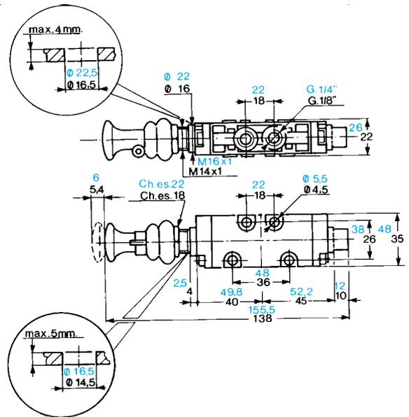
Ventil 3/2 mit langem und kurzem Hebel vorne G 1/8 - G 1/4
