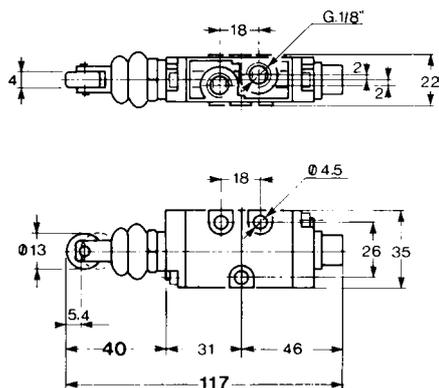
Ventil mit Rollenstößel mit Staubschutz 5/2 - G 1/8
