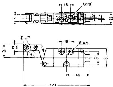
Ventil 5/2 mit Rollenhebel - Leerrücklauf G 1/8
