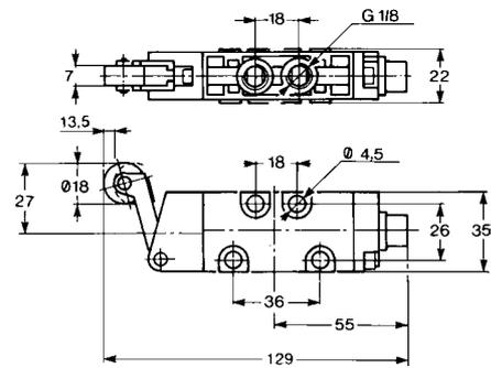
Ventil 3/2 mit Rollenhebel - Leerrücklauf G 1/8
