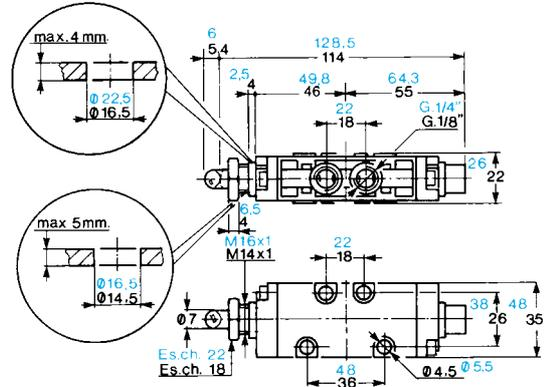
Ventil mit Kugelstößel mit Staubschutz 3/2 - G 1/8
