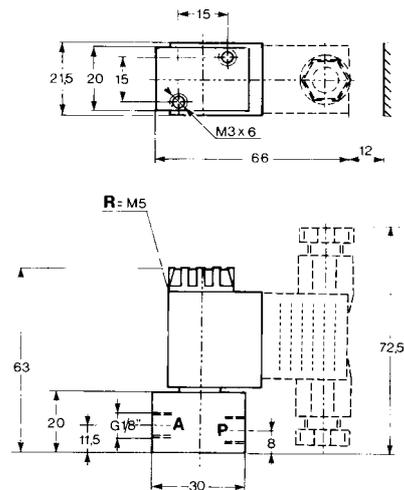
**PILOTVENTIL U1 CNOMO für Montage auf Grundplatte SPEED U2**
