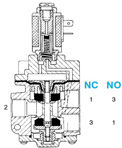
Magnetventile 3/2 für Vakuum mit Vakuum indirekt gesteuert
