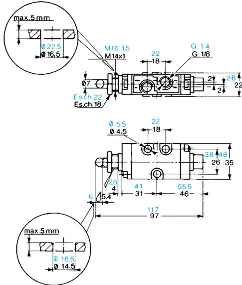
Ventil mit Kugelstößel 5/2 für Schraubenbefestigung - G 1/8 - G 1/4
