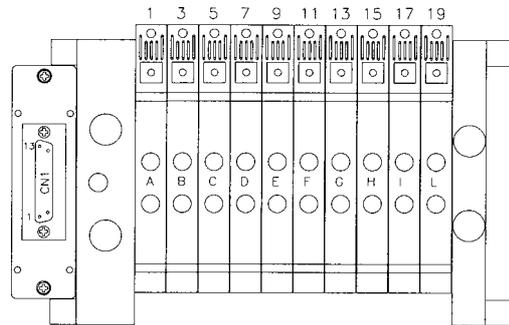
Beispiel zur Positionsidentifizierung in einer Batterie Typ C, gemischt, bistabil und monostabil, max. 20 out, Modul TIM06B verwenden
