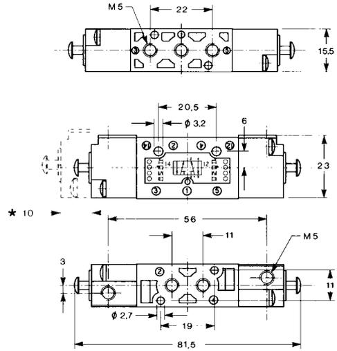
Ventil 5/2 - Einseitiger elektrischer Impuls (Ventilgehäuse mit Gewinde)
