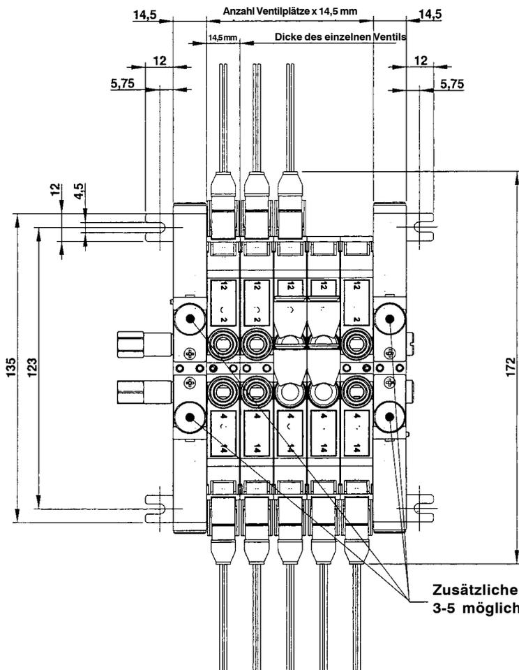
Serie PSR mit Eintrittsplatte 26 mm und Endplatte 14,5 mm
