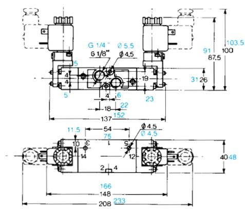
Doppelter elektrischer/pneumatischer Impuls mit Pilotventil U1 in Linie/L und pneumatischem Impuls am Ventilgehäuse
