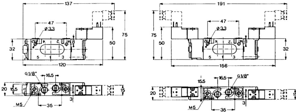
Elektrischer Einzel-Doppel - Impuls mit Pilotventil 15 mm um 90° gedreht und Miniatur-Stecker in Linie - Spule U05
