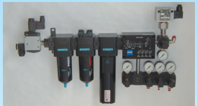
Luftaufbereitung einer Messmaschine mit feinstgefilterter und getrockneter Druckluft
