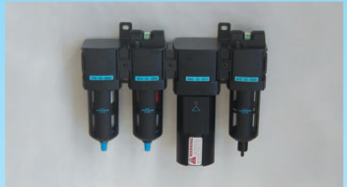
Luftaufbereitung einer Laser-Kunststoffschneidemaschine mit Vorfilter, Feinstfilter, Membrantrockner und Aktivkohlefilter.
