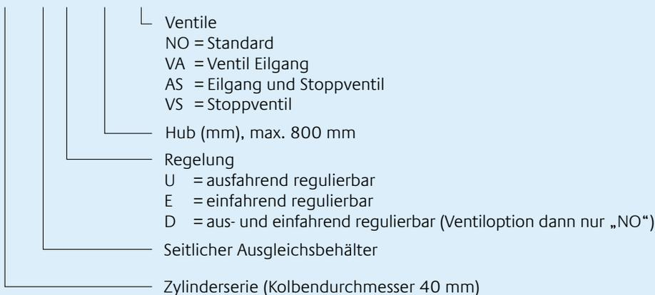
Ölbremsszylinder P40 mit seitlichem Ausgleichsbehälter (RP), ausfahrend regulierbar (U), der Hub beträgt 100 mm (100) und das Ventil (NO) ist Standard.
