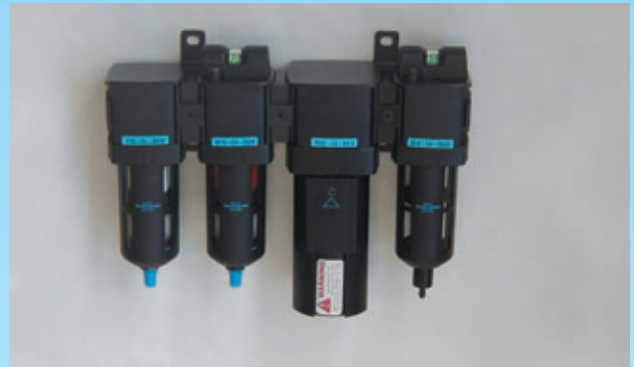
Luftaufbereitung einer Laser-Kunststoffschneidemaschine mit Vorfilter, Feinfilter, Membrantrockner und Aktivkohlefilter.
