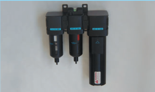
Luftaufbereitung einer Lackierstation mit Vorfilter, Feinfilter und Membrantrockner.
