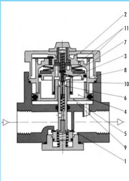
Bei kleinsten Geräteabmessungen sind die Manoregler für die Druckregelung großer Volumenströme bei geringstem Druckabfall sehr gut geeignet. Der leichtgängige und großdimensionierte Einstellknopf ermöglicht auch
