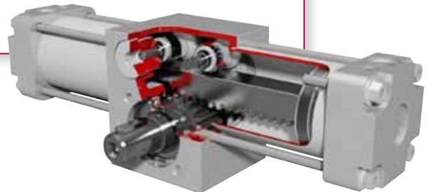
Der Drehantrieb DSO ist ein Hochleistungsantrieb für Pneumatik-, Hydro-pneumatik- und Niederdruckhydraulik-Betrieb. Der Drehantrieb wandelt über die Zahnstangen-Ritzel-Kombination eine begrenzte geradlinige Bewegung der Zahnstange in eine Drehbewegung des Ritzels um.
