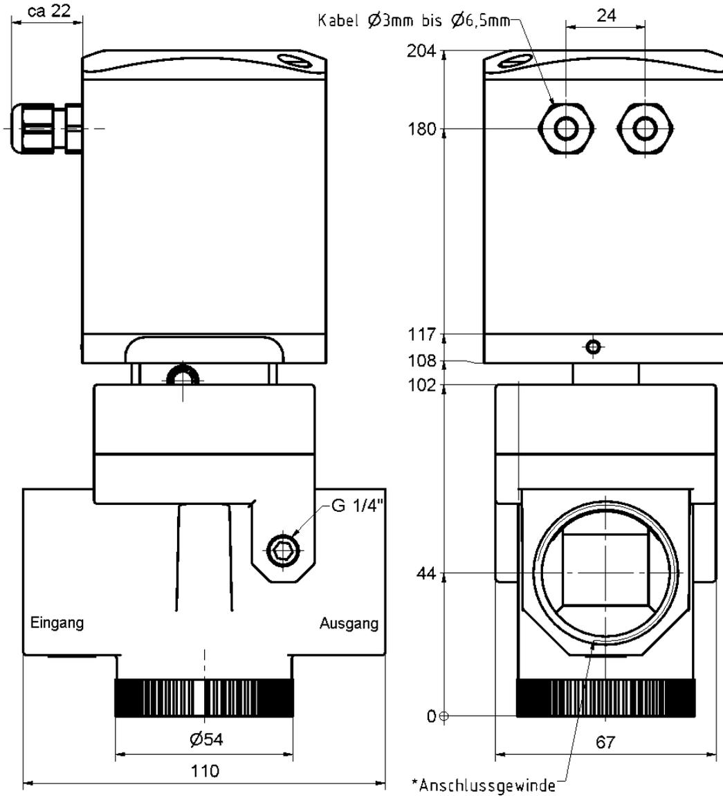
\* G3/4" bei B1, G1" bei B2, G1-1/4" bei Ausführung B3
